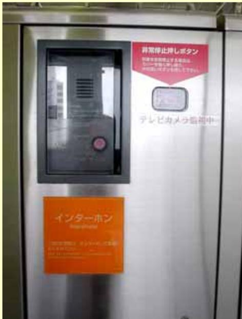
電車を緊急停止させる必要が生じたときは、非常停止押しボタンを押して下さい。
