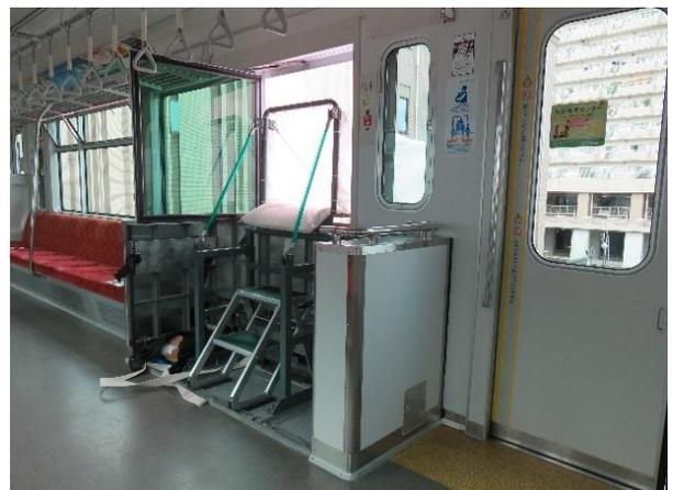
車両の窓から地上に下ろしたシューター（左写真：車外・右写真：車内）
