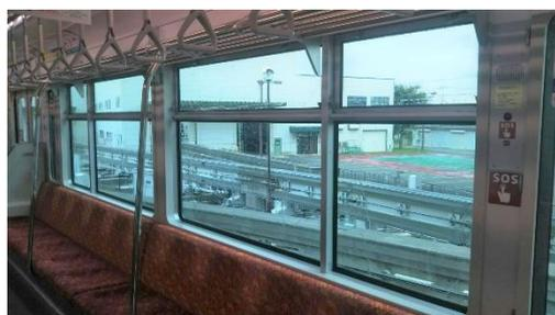
モノレール車内の衛生対策とし、抗菌材を練り込んだ吊り手へ変更しています。
