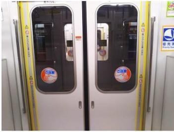
車両扉への引き込まれ防止のため、ステッカーで注意喚起しております。表示は大人を目線と子供の目線で表示を変更し、材質についても滑りやすいものを採用いたしました。
