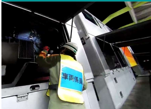
車両係員によるホーム下（線路内）での車両点検
