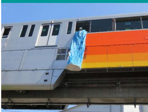
脱出シューターを車両から地上に投下
